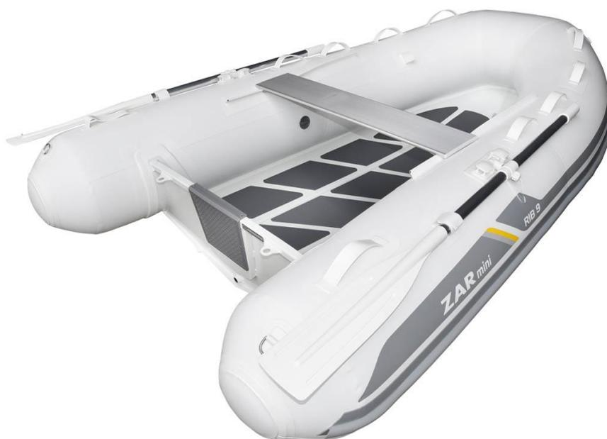
Schlauchboot mit pulverbeschichtetem Aluminium-Festrumpf
